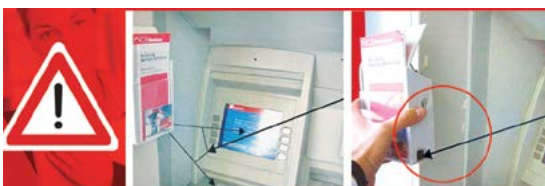
Fig.2 La microcamera nascosta nel portadepian inquadra la tastiera ....
